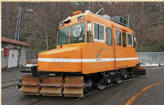
最新型は、2019年に完成した「雪20形(雪21号車)」。ブルームの駆動方式をパワフルな三相永久磁石形同期電動機とし、湿った重い雪でもしっかり除雪することが可能。さらに、従来の直接制御方式から間接制御方式へ変更する等、随所に改良を施した車両となっています。
