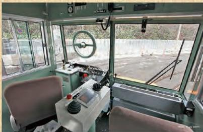
運転席には電車を動かすコントローラーと、ササラを動かすタッチパネル式操作盤があり、2人で動かします。飛ばした雪が人や車に当たらないよう、気をつけて運転しているそうです。
