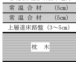
〔欠損部補修断面(2層)〕
