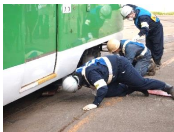
脱線復旧用具をセットする様子
