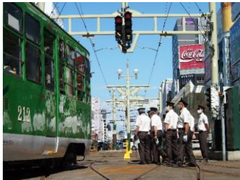
転てつ器と信号の動作を確認する様子
